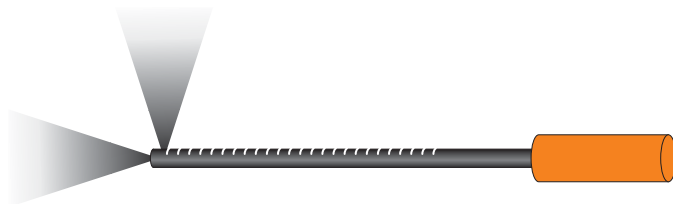
Figure 33. Les faisceaux de détection de la sonde foreuse
