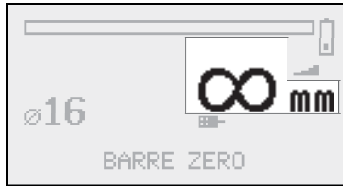
Figure 14. Épaisseur de couche hors plage de mesure (infinie)
