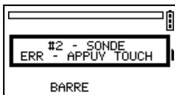
Figure 35. Exemples de messages d'erreur – sonde non connectée.
